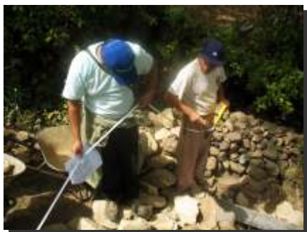
Foto N° 06: Levantamiento Topográfico con el uso de GPS y Wincha. Secllas.
